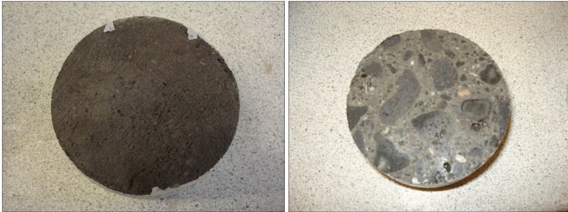
Mynd 3. Sýni með ósagað yfirboð (tv) og sagað yfirborð (th).
